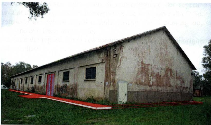
Simulazione realizzazione marciapiede e rampa carrabile
